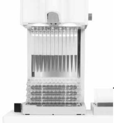
Fig. 3 : La distribution répétée permet le remplissage rapide des microplaques
